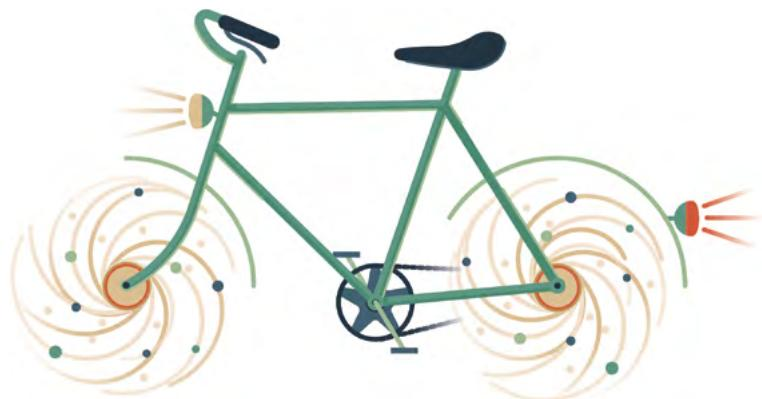
una bobina eléctrica en cuyo centro hay un imán que gira solidariamente con la rueda de la bici. Al rotar el imán cuando pedaleamos se produce un campo magnético variable en el tiempo, que a su vez crea una corriente eléctrica en la bobina. En términos electromagnéticos, como se ve, es el fenómeno inverso al del solenoide.
